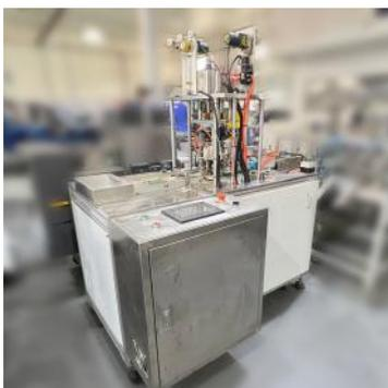
Máquina de soldar elástico em máscara PFF2 da marca DELTA
