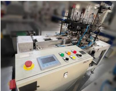
Máquina de soldar elástico de máscara tripla da marca INOVTE
