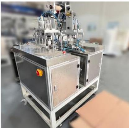
Máquina de soldar elástico de máscara tripla
