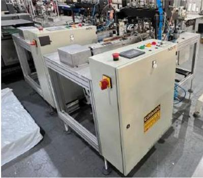
Máquina de soldar elástico de máscara tripla da marca INOVTE
