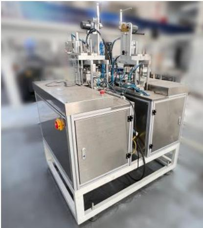
Máquina de soldar elástico de máscara tripla
