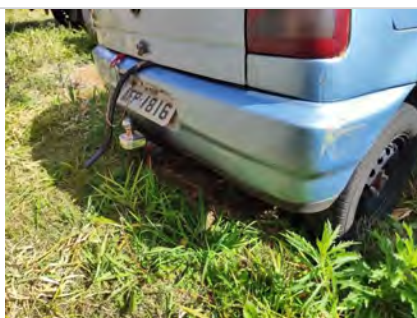
Paracheque Traseiro: AVARIADO
