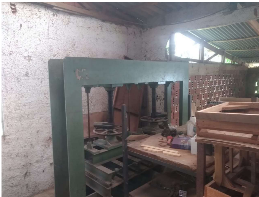
5 - Prensa manual de parafuso 2,30m ferro fundido
