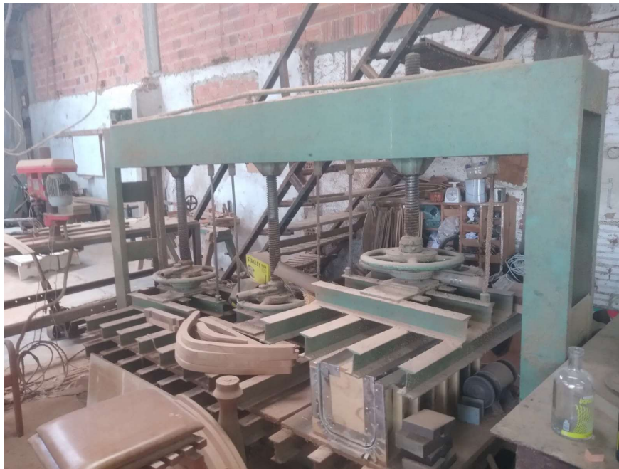
4 - Prensa manual de parafuso 3,30m ferro fundido
